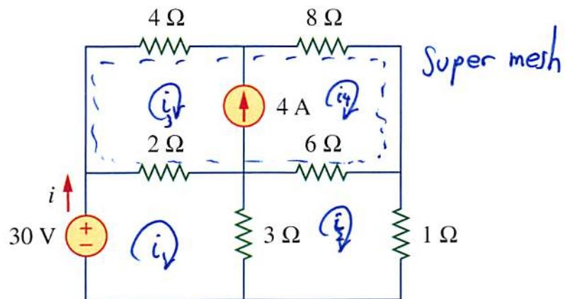
$$\text{Supermesh: } 2(i_3 - i_1) + 4i_3 + 8i_4 + 6(i_4 - i_2) = 0$$
